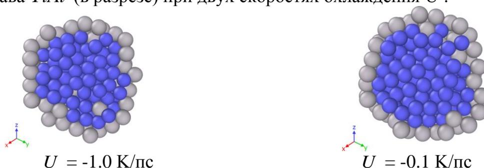
*Рис. Конечные конфигурации TiAl (атомы алюминия – светло-серые)*
