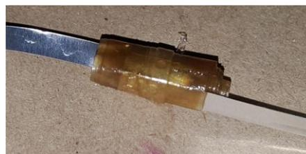
*Рис. 2. Изображение сегмента конденсатора*
